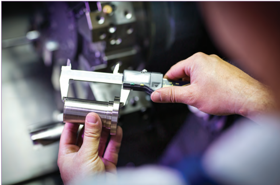
قياس الأبعاد أثناء عملية التصنيع
