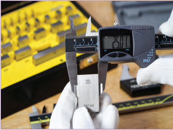
فحص الدقة باستخدام المعكات المعيارية
