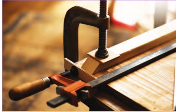
استخدام المشبك في أعمال النجارة
