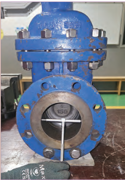
استخدام ناقل المقاييس التلسكوبي
