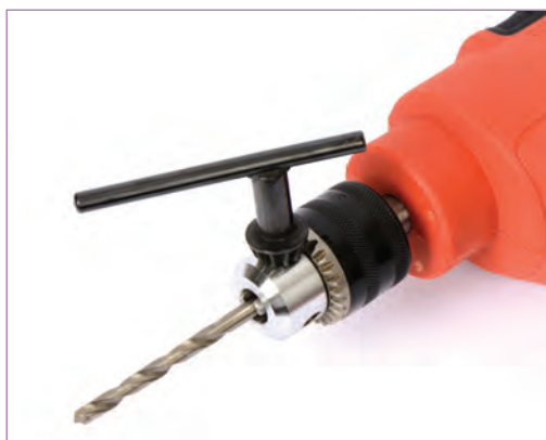
مفتاح الظرف في المثقاب الكهربائي
