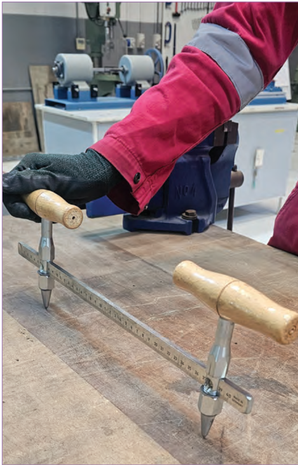
استخدام الفرجار ذو النطاق الواسع لرسم الدوائر بأقطار كبيرة نسبياً
